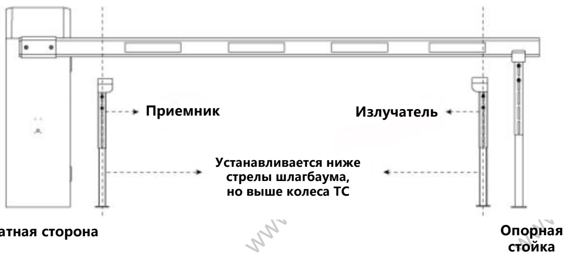
Установка фотоэлемента
