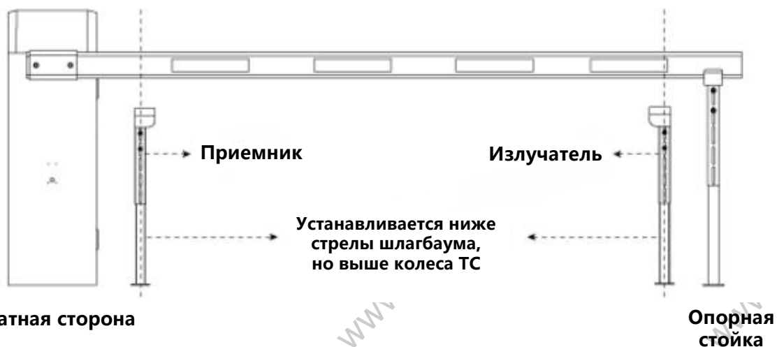
Установка фотоэлемента
