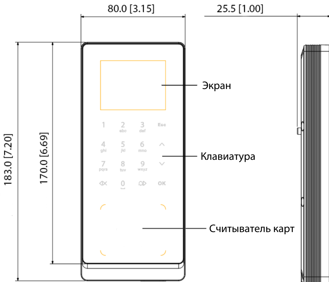
Рисунок 1–2 Габаритные размеры (2) (мм [дюймы])
