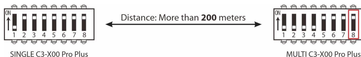
Рисунок 5-5. Положение переключателя для подключения терминатора
