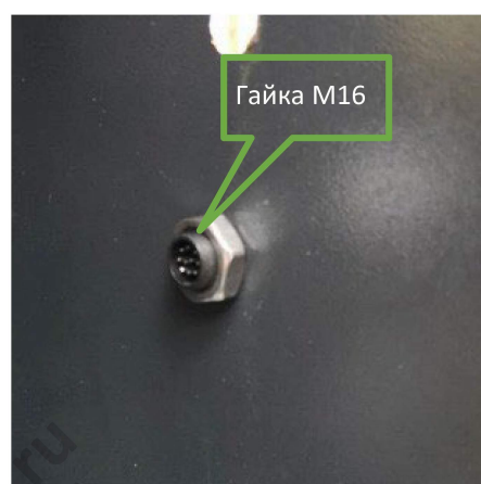
(b) Прокладка проводки через прокладку и гайку
